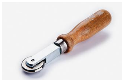
Прикаточный ролик Используется при работе в углах.
